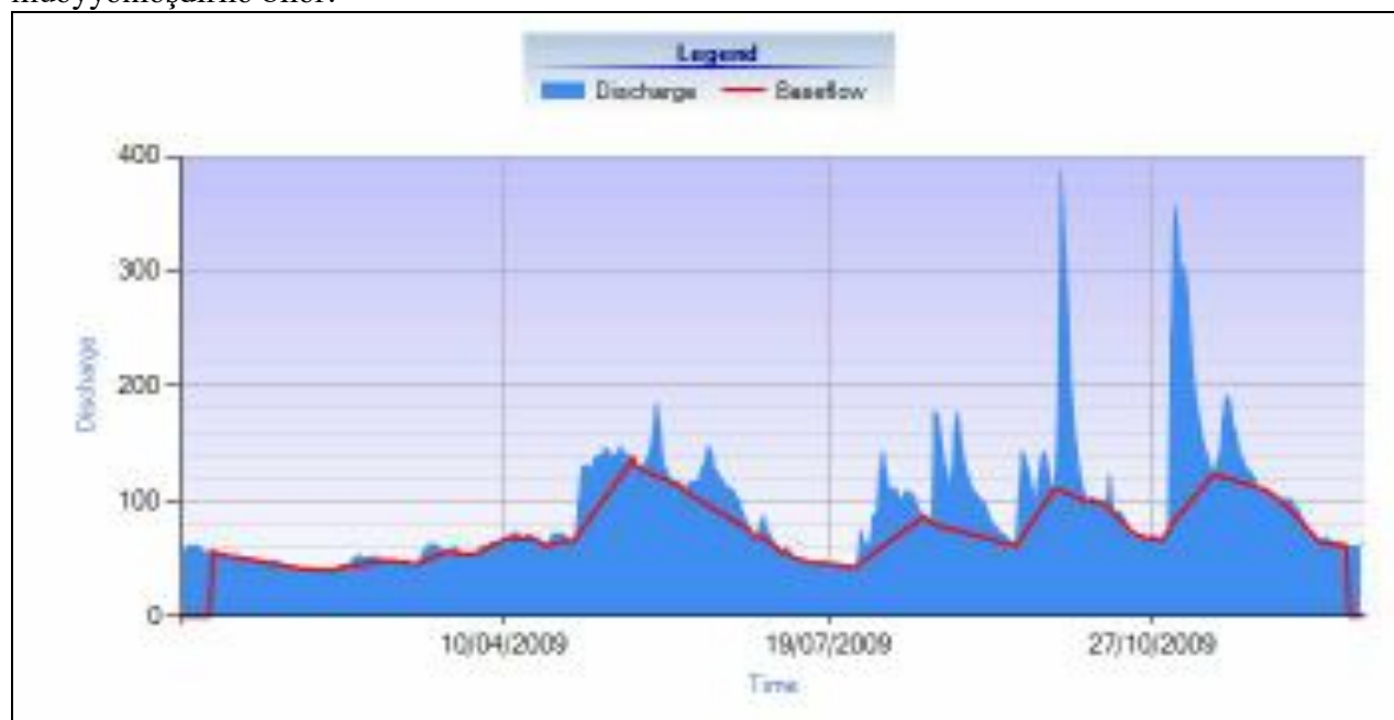
Şəkil 4.1: Əsas Axın İndeksi metoduna əsaslanan axın komponentlərinin ayrılması (Alazan/Qanıx-Əyriçay, 2009)
