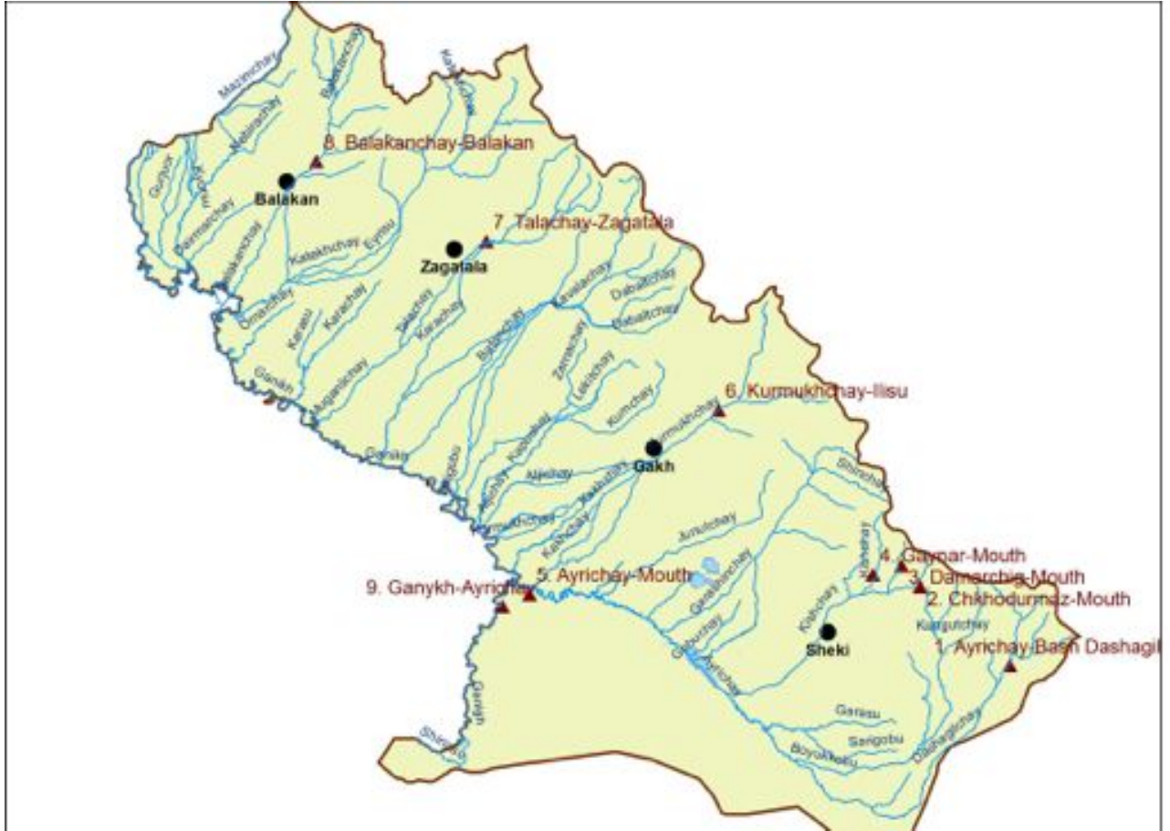
Şəkil 4.3: Azərbaycanca Alazan/Qanıx Çayı hövzəsində su kəmiyyətinin monitorinqi üçün fəaliyyətdə olan hidroloji stansiyaların (qırmızı üçbucaqlarla müəyyən edilmişdir) xəritəsi
