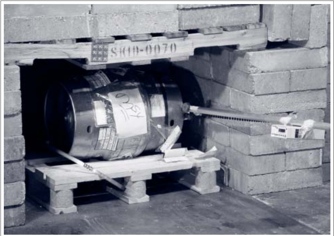
Behållarens strålning mäts som första steg i inspektionen i New Orleans.
