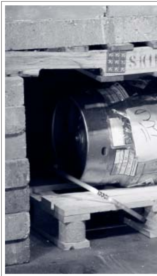
Behållarens strålning mäts som första steg i inspekt
