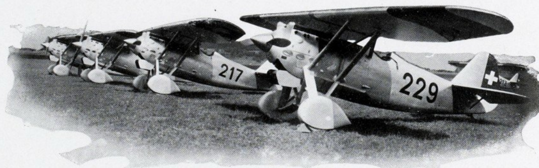
Le Dewoitine 27 moteur Hispano-Suiza 500 CV 12 Mb est fabriqué en grande série pour l'aéronautique suisse.
