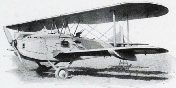
Le Levasseur 45 moteur Hispano-Suiza 600 CV 12 Lbr est en service dans l'aéronautique maritime.
