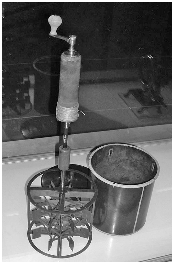
Figura 7 - Aparato original utilizado por James Joule. Fonte: wikipedia
