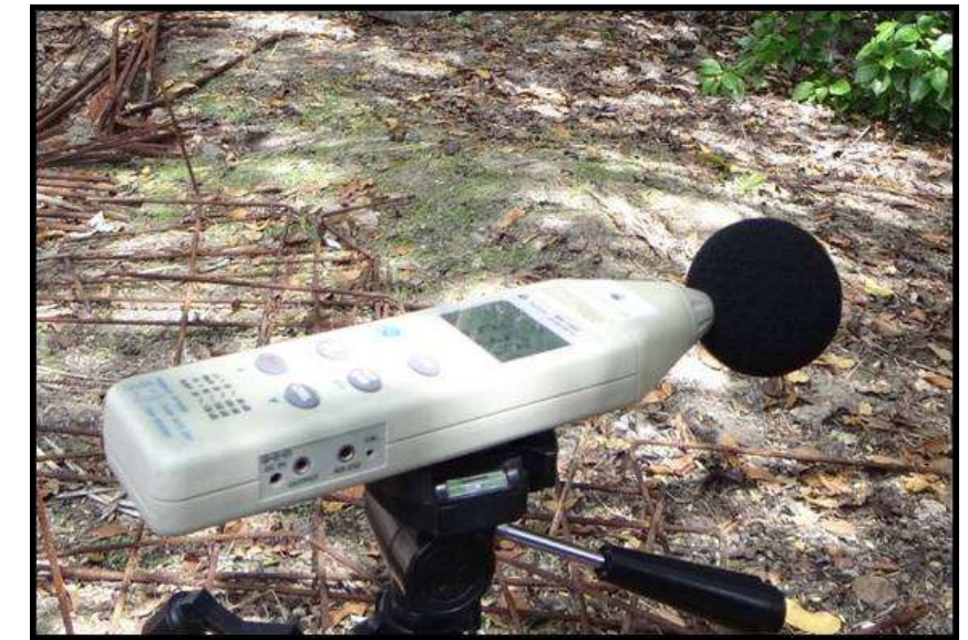
Figura 11. Medidor de nível de pressão sonora digital utilizado pela equipe da CARUSO JR. E. A. E. para determinar os níveis de pressão sonora. Foto: CARUSO JR. E. A. E., 2012.
