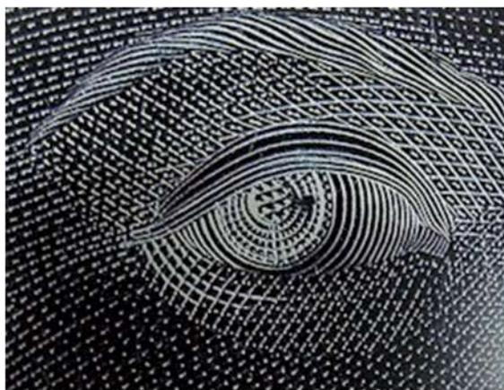
Miles de líneas cuidadosamente trazadas una a una forman las texturas, volúmenes y claroscuros del retrato y las viñetas. El grabado a buril se realiza con la imagen invertida en una placa de acero cortando directamente sobre el metal, a tamaño real, con la ayuda de un microscopio.
