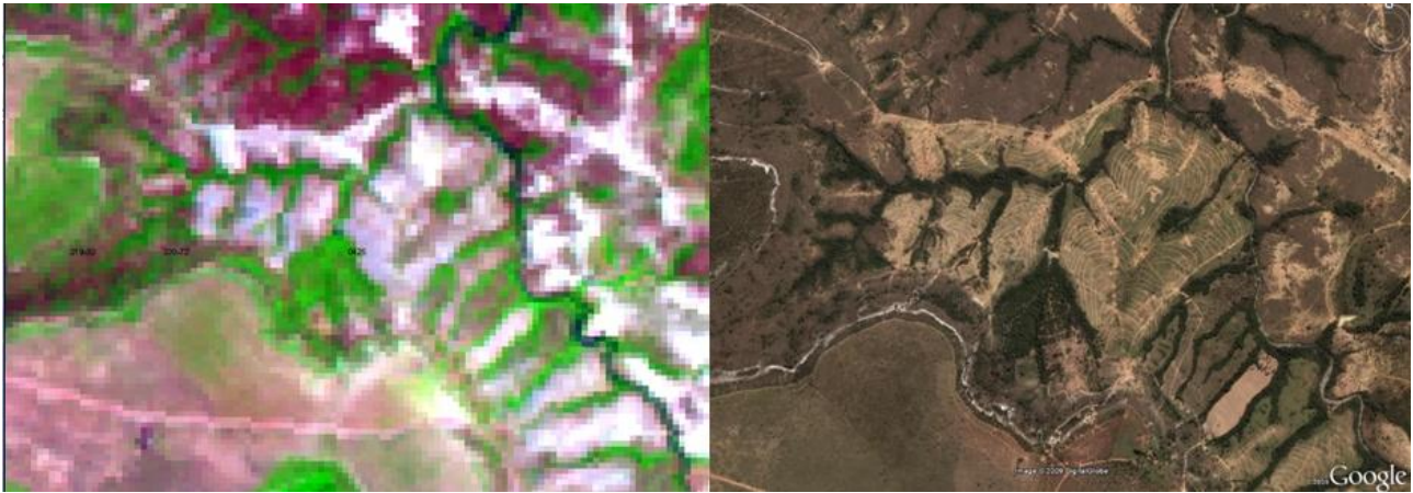
Figura 8. Imagem Landsat TM (30 metros de resolução espacial) (a) e imagem disponível no programa Google Earth (1 metro de resolução) (b), ilustrando o nível de detalhamento dos alvos no seu processo de validação.
