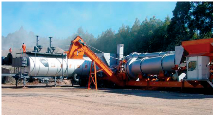
Figura 8.4 Exemplo de uma usina asfáltica contínua (Foto: Ciber Ltda.)
