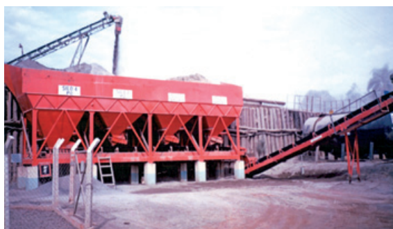
Figura 8.7 Exemplo de sistema de silos frios
