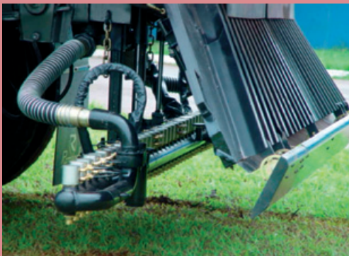
(c) Detalhes dos sistemas de aplicação de ligante asfáltico e de agregado
