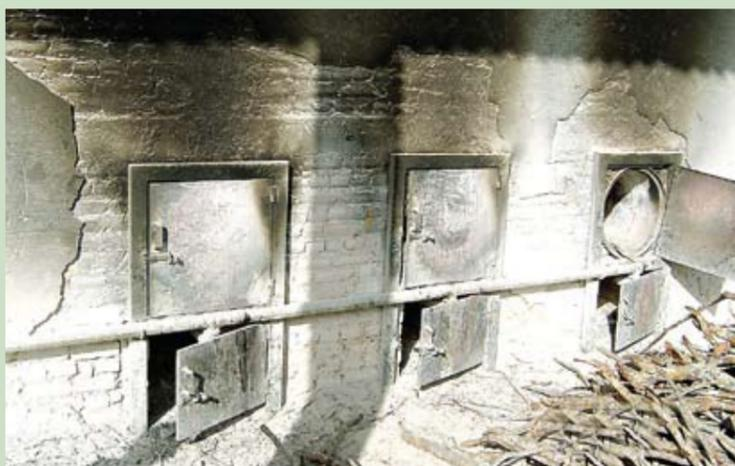
Figura 21 - Calcinadora de gesso no município de Trindade/PE.
