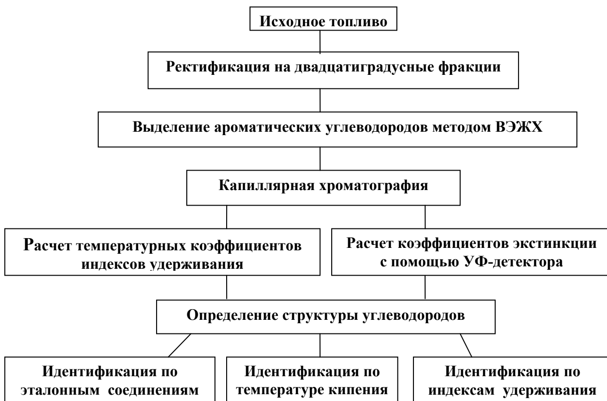
Рис. 10. Схема идентификации ароматических углеводородов реактивных топлив
