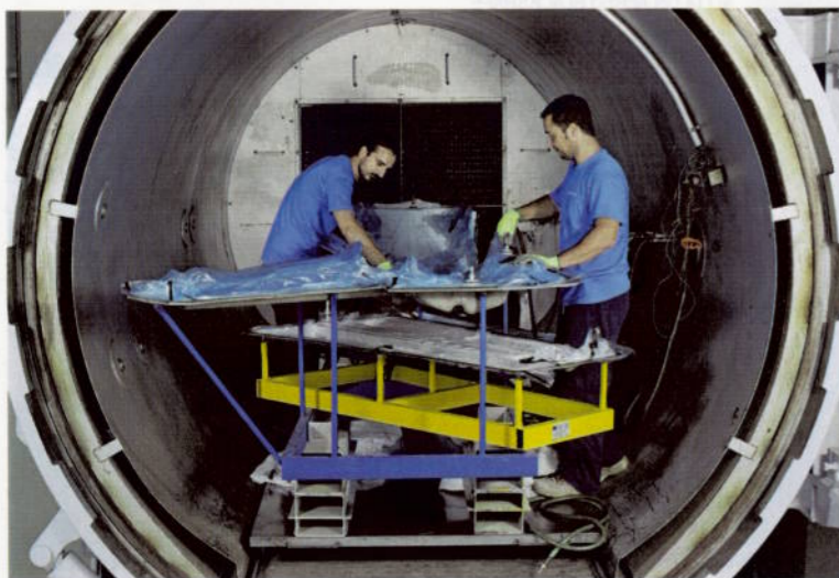
LE SINGOLE PARTI DEL VELIVOLO SOTTOPOSTE AL "CICLO DI CURA IN AUTOCLAVE"
