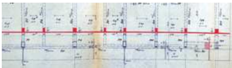
Fig. 10 – Edifício Acapulco – laje de transição – nervurada invertida, em detalhe. Fonte: Arquivo Municipal de Campinas.
