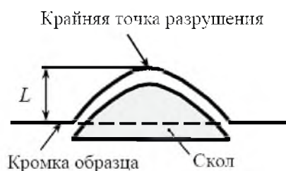
Рис. 2. Схема измерения размеров шрама скола на поверхности испытанного образца.
