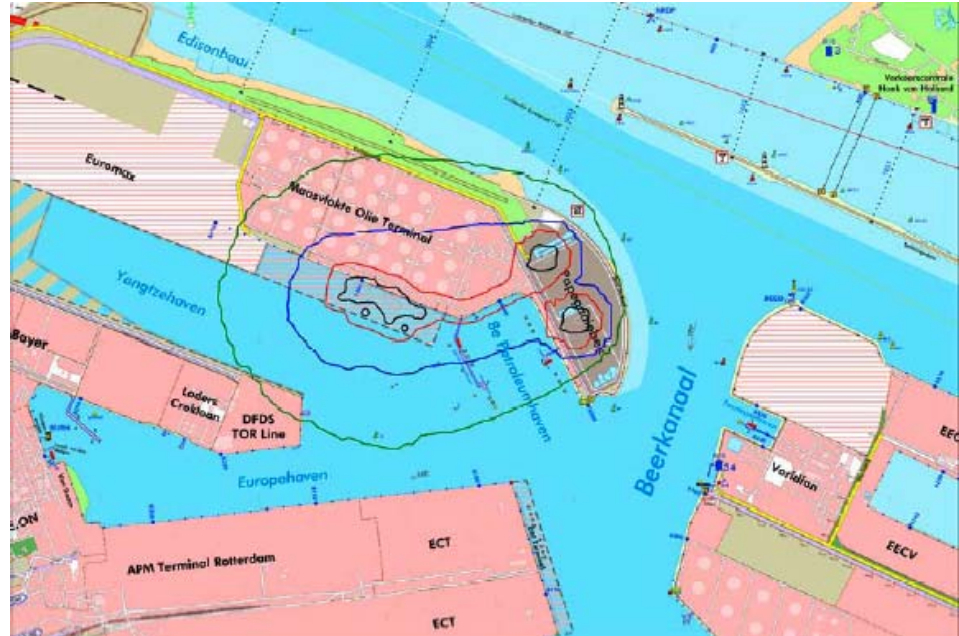
Figuur 3.2: Plaatsgebonden risico LNG-terminal (totaal)
