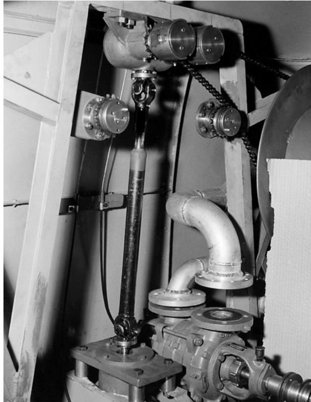
*Antrieb für Pumpe und Schlauchtrommel in einem
