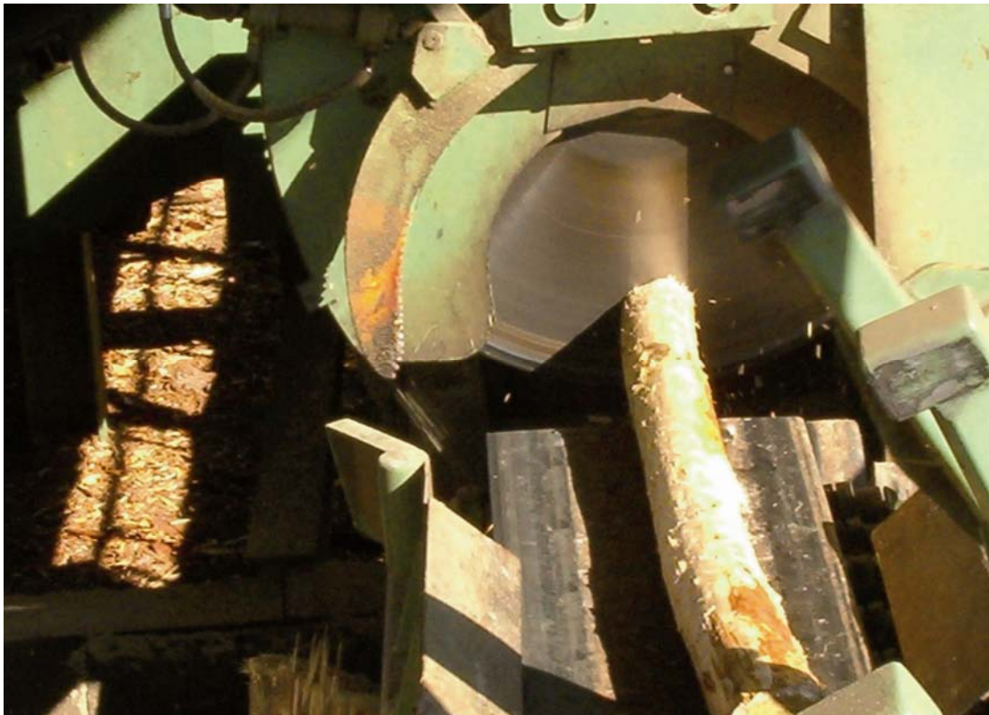
Abb. 17: Voll automatisches, mannloses Ausformen der Hölzer im Sägewerk.
