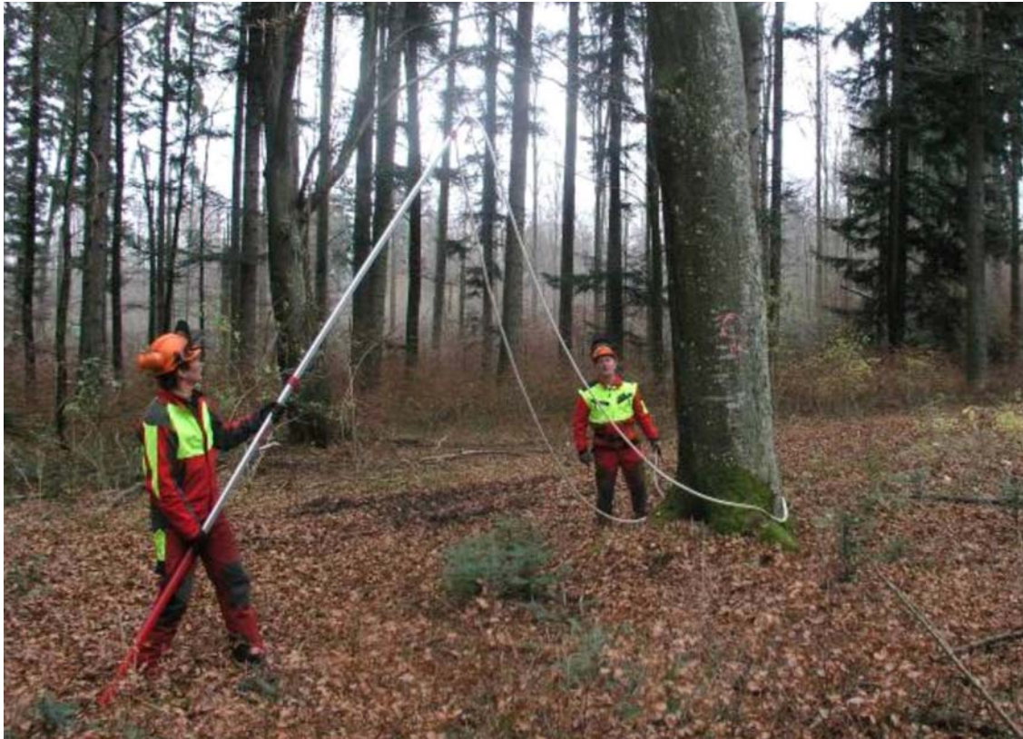
Abb. 21: Mit der Schubstangentechnik lassen sich Zugseile befestigen, ohne den Baum zu erklettern.
