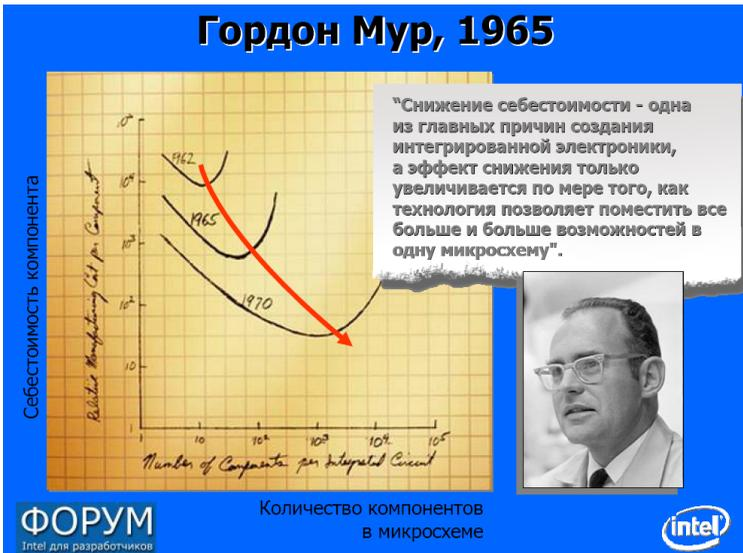
Рис. 3.11 Динамика снижения стоимости микросхем с ростом количества компонентов в микросхеме [3.70]
