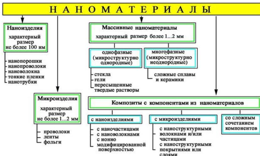
Рис. 3.8. Классификация наноматериалов
