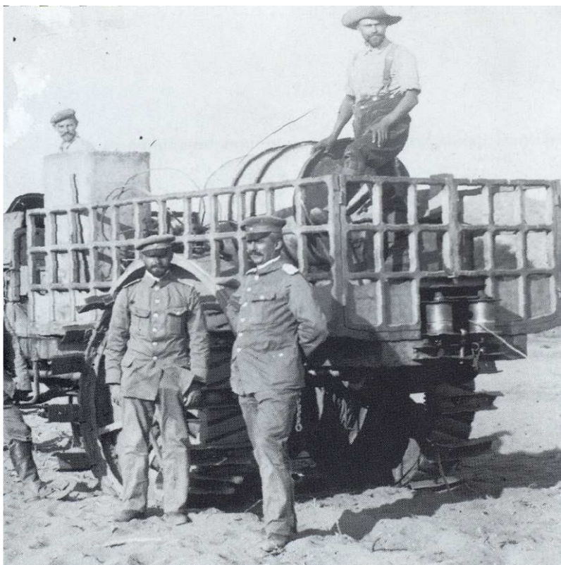
Einer der ersten Lastkraftwagen der deutschen Schutztruppe in Südwestafrika. Am Heck Trommeln für Stahlkabel als Seilzüge beim Steckenbleiben.
