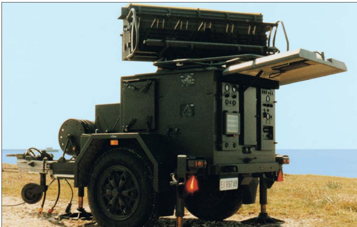
*Il radar di avvistamento e sorveglianza Contraves LPD/20-J. Questo Shorar di prima generazione ha equipaggiato le btr. da 40/70 ed è attualmente in dotazione alle batterie a cortissima portata equipaggiate con i sistemi d'arma SIDAM e STINGER*
