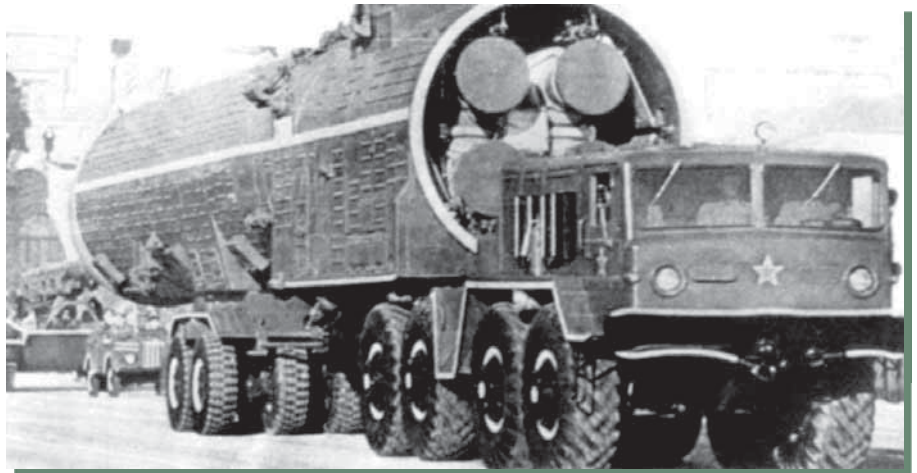
5. KÉP Az A-350 típusú elfogórakéta szállító járművön, konténerben
