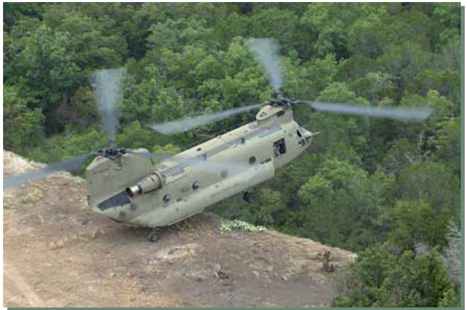
4. KÉP Egy CH-47F típusú helikopter, az ún. Pinnacle (orom) manőver közben
