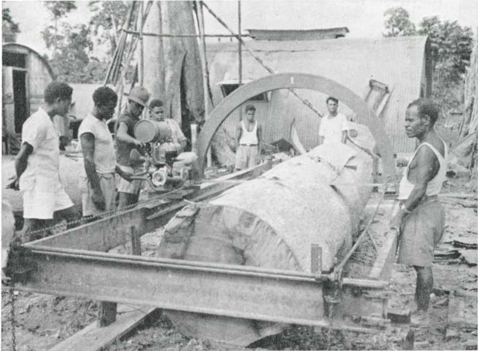
Foto 4. Een experiment met een „Dolmar“-overlangs-zaag, welke hier een Intsia-(ijzerhout)-stamstuk in platen van \pm 7\frac{1}{2} cm dikte verzaagt, met Papoea-werkkrachten onder Europees technisch toezicht. Het principe van dit motorzaag-type is goed: de geveldde boom in het bos kan ter plaatse in kleinere stukken verdeeld worden, hetgeen besparing op transport betekent. Het experimentele stadium is men echter nog niet te boven. 1952.
