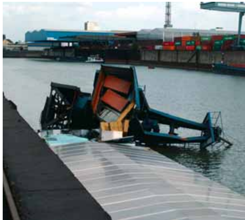
Abbildung 17: Durch Winddruck umgestürzter Verladekran im Duisburger Rheinhafen
