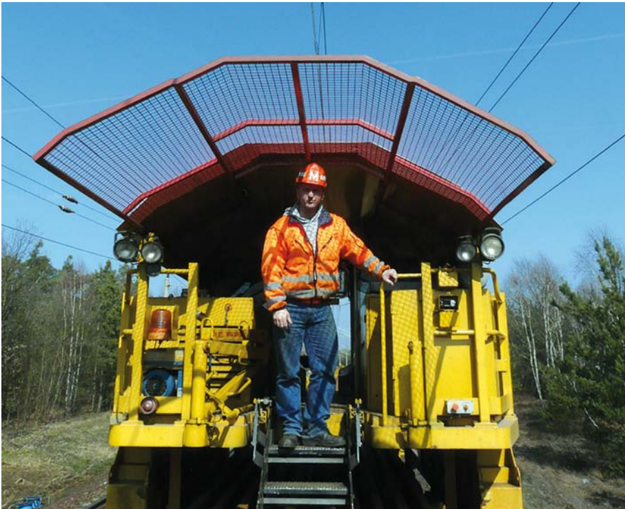
Abbildung 5: Arbeiten unter Schutzgitter – nur im Ausnahmefall wenn zusätzliche Aufsichtsführung das Verlassen des Schutzraumes verhindert
