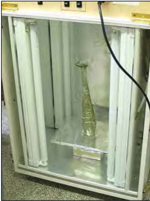
Abbildung 6-6 Zwischenzustand Objekt A; geheftetes Gefäß vor der Belichtung.
