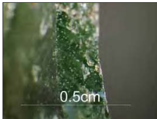
Abbildung 1-21 Vorzustand Objekt B; mikr. Vergr.: 6,4; zweischichtiger Aufbau des Fußes in einer Bruchfläche des Fußes.
