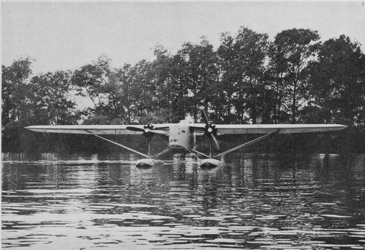
Le CAMS 60 en essais à Sartrouville (large train de flotteurs assurant d'excellentes qualités marines et un dégagement parfait pour le lancement de bombes ou de torpilles).
