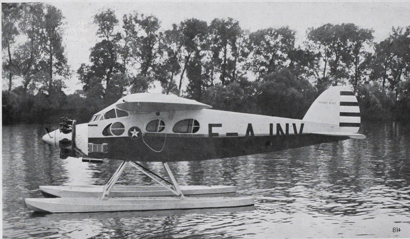
Un avion Nieuport de la S.T.A.R., équipé de flotteurs, effectue ses essais en hydravion à Sartrouville.
