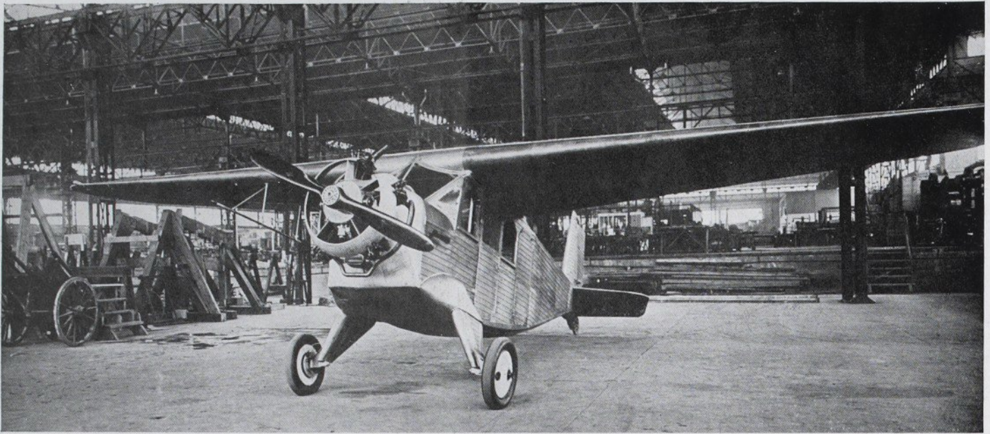
L'avion postal léger D.B. 81, entièrement métallique, moteur « Lorraine 120 C. V. ».
