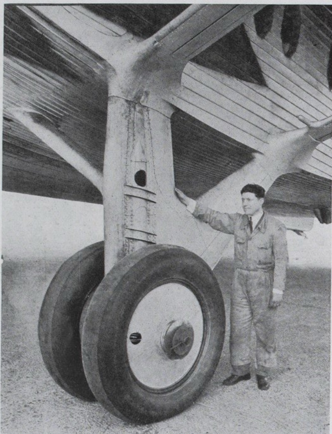
L'atterrisseur de gauche avec ses énormes roues jumelées de 1300 \times 275 , son amortisseur et ses deux jambes de force.
