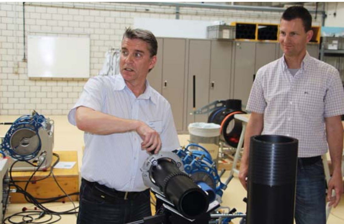
KPM:n hallituksen jäsen Terho Möttönen kuorii putkesta piilaimella 0,2mm lastun.
