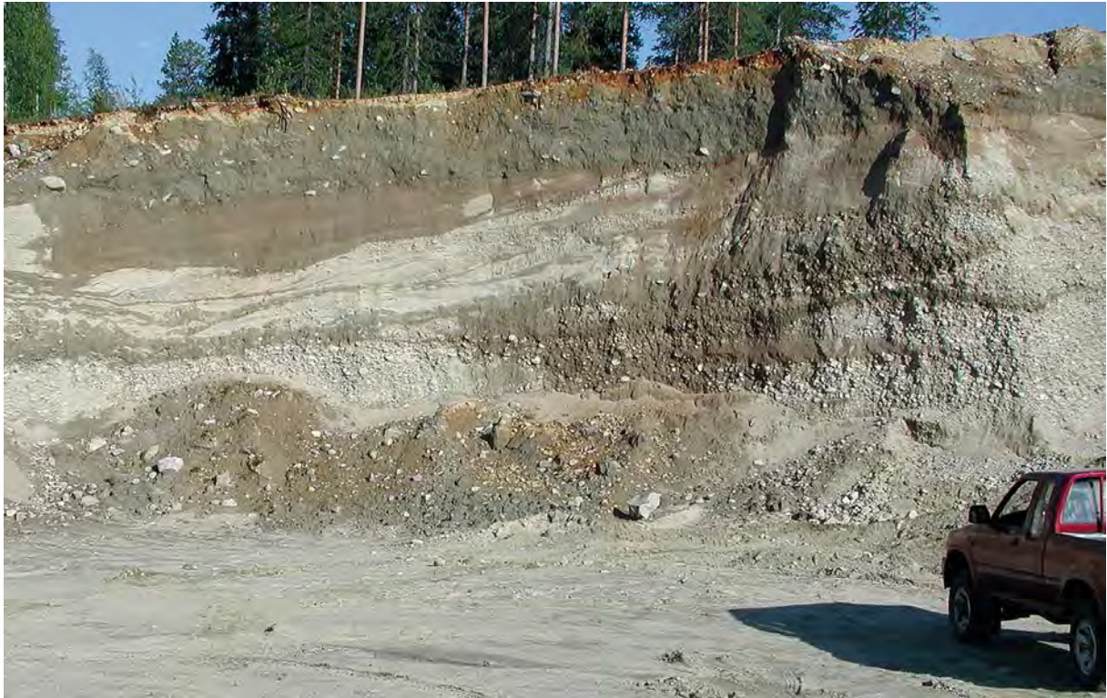
Kuva 73. Saeharjun (MOR-Y12-080, seudullinen kohde) drumlinisoituneen harjun leikkaus, jonka korkeus on noin seitsemän metriä. Harjun hiekkaa ja soraa peittää leikkauksen yläosassa oleva noin puolentoista metrin paksuinen moreenikerros. Kuva: K. Mäkinen, GTK.
