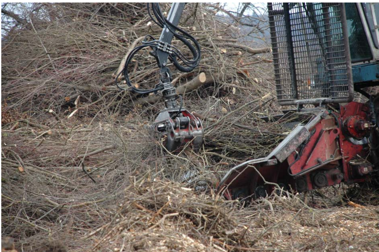
Bild 12 und 13: Umgebauter Maishäcksler; Einschubtrichter des Häckslers.
