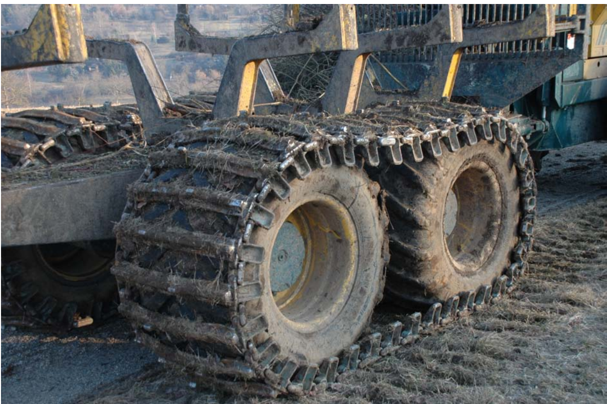
Bild 7 und 8: Tragschlepper beim Rücken; Boogiebänder auf der Tandemachse.
