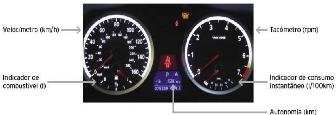
Fig. - Instrumentos principais indicadores do consumo do veículo
