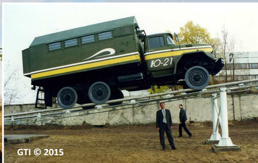
А.Э. Юницкий демонстрирует надёжность путевой структуры, стоя под 15-тонным ЗИЛ-131
