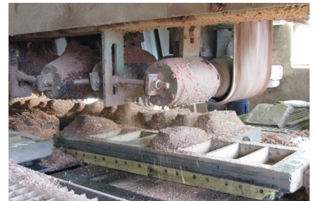
Foto 5: vormen van een handvormsteen d.m.v. een machine die de kleimassa in de vorm 'werpt'.
