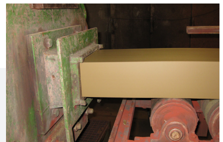
Foto 7: Voorbeeld waarbij de klei uit de persmond wordt geperst
