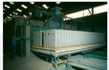
Foto 11: Gedroogde stenen staan klaar om de tunneloven in te gaan.
