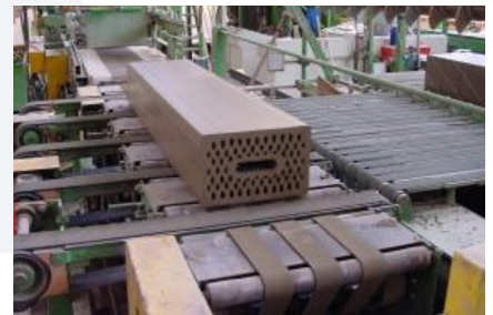
Foto 8: De klei uit de strengpers wordt dan in de gewenste baksteensteenformaat gesneden.
