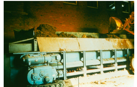
Foto 2: Het laden van de klei in de kneedmachine.
