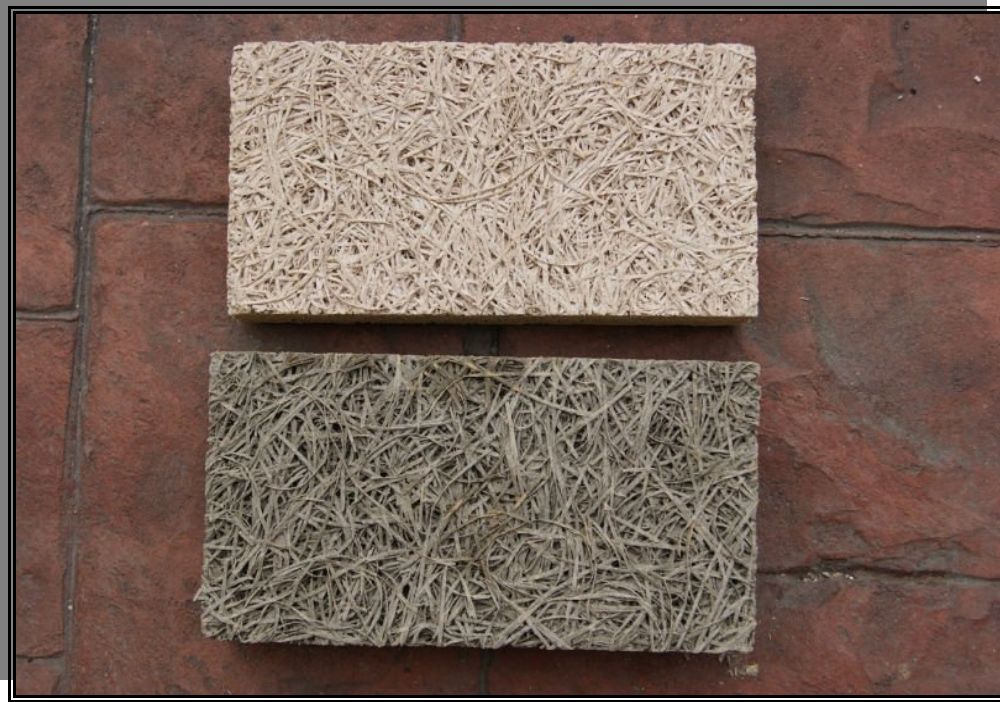
Figura 7. Tabique de Aserrín y Cemento.
