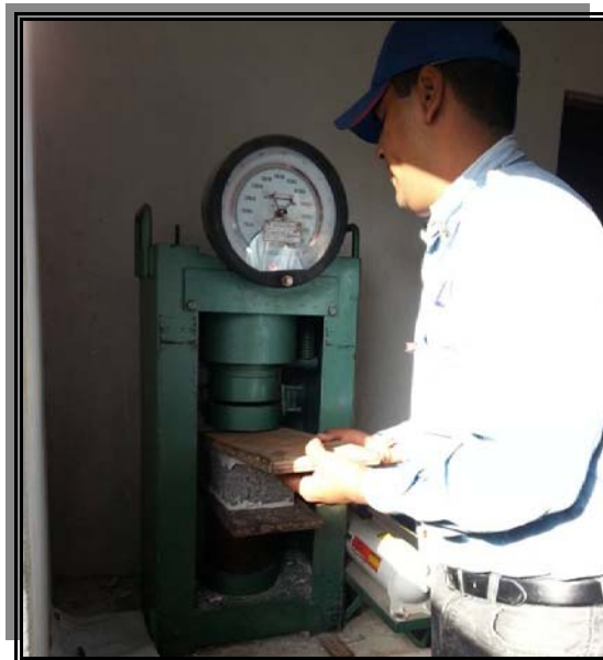
Figura 33. Colocación de Tabiques en Prensa.
