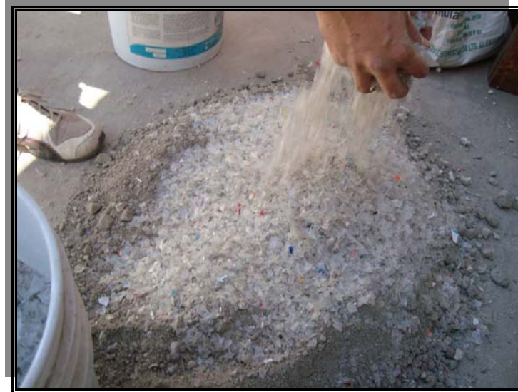
Figura 21. Añadiendo material sustituto PET.
