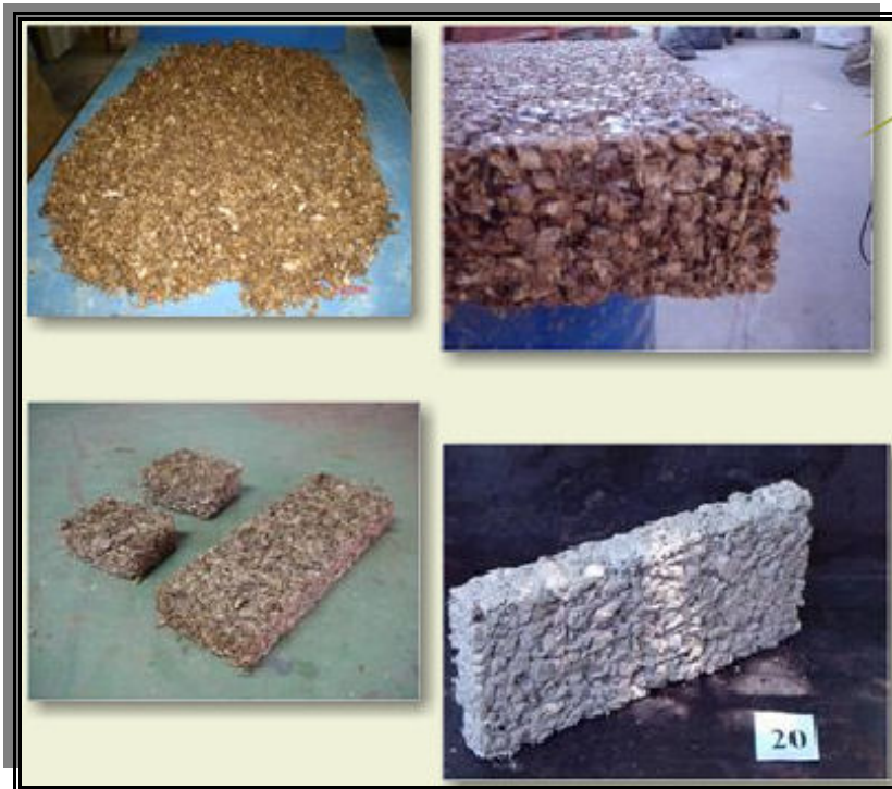
Figura 2. Elementos creados con cáscara de cacahuate.
