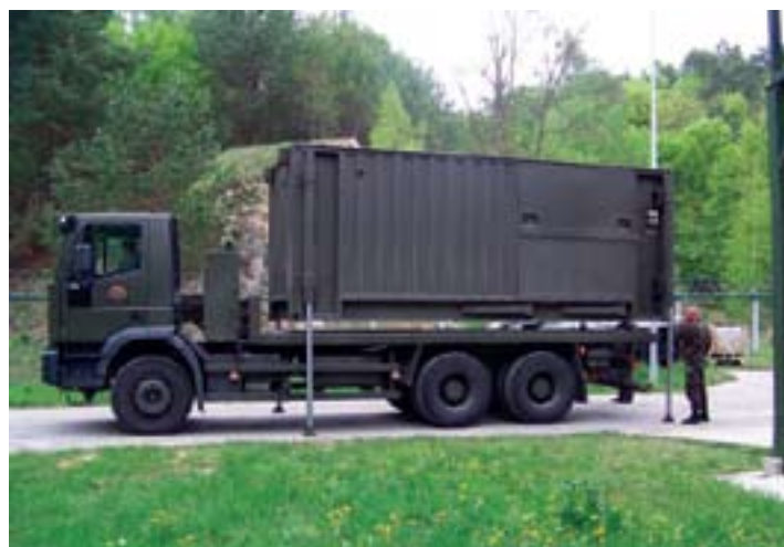
Mobilni kemijski laboratorij podjetja EM TRONIC iz Maribora. S pomočjo hidravličnih nog ga lahko naložimo na tovorno vozilo. Vsebuje aparature potrebne za varno identifikacijo bojnih strupov in nekaterih toksinov.
