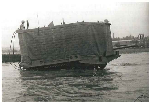
Med hjälp av en inbyggd uppfällbar flytbalg kunde Stridsvagn 103 "simma" med en hastighet av 6 km/h.
