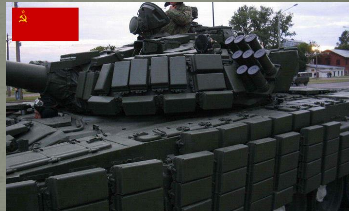
Explosivt reaktivt pansar (ERA) – initialt (1982) 3/3/3 mot RSV – senare 2 x 2/7/2 mot tandem
