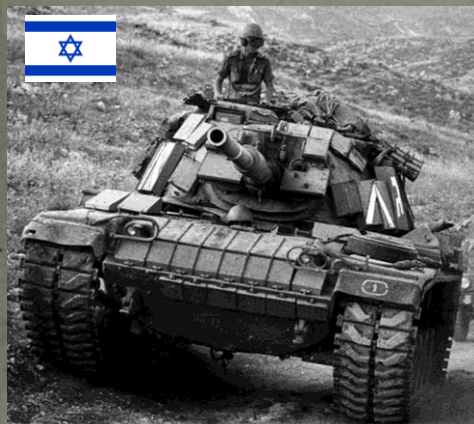
Explosivt reaktivt pansar (ERA) – initialt (1982) 3/3/3 mot RSV – senare 2 x 2/7/2 mot tandem
