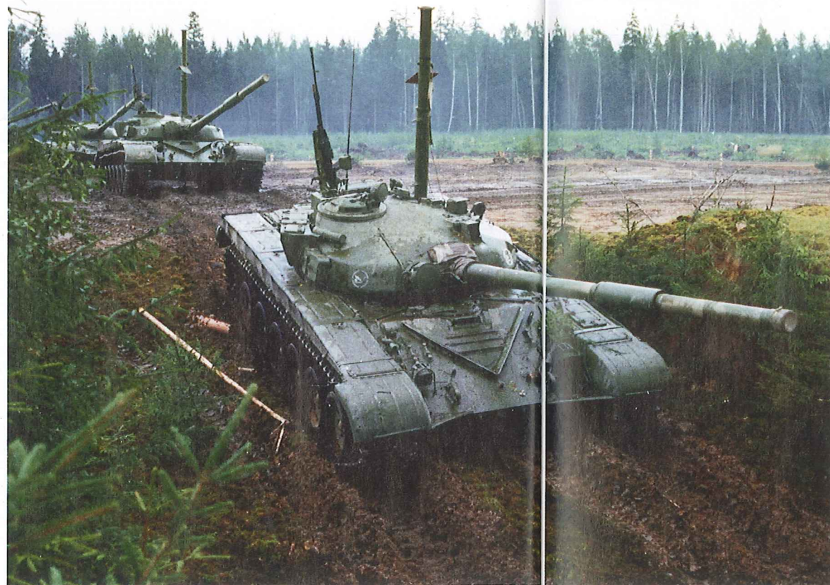
T-72:or utrustade med snorklar (till höger om tornen) under en övning. Stridsvagnarna kunde djupvada ner till fem meters djup.
