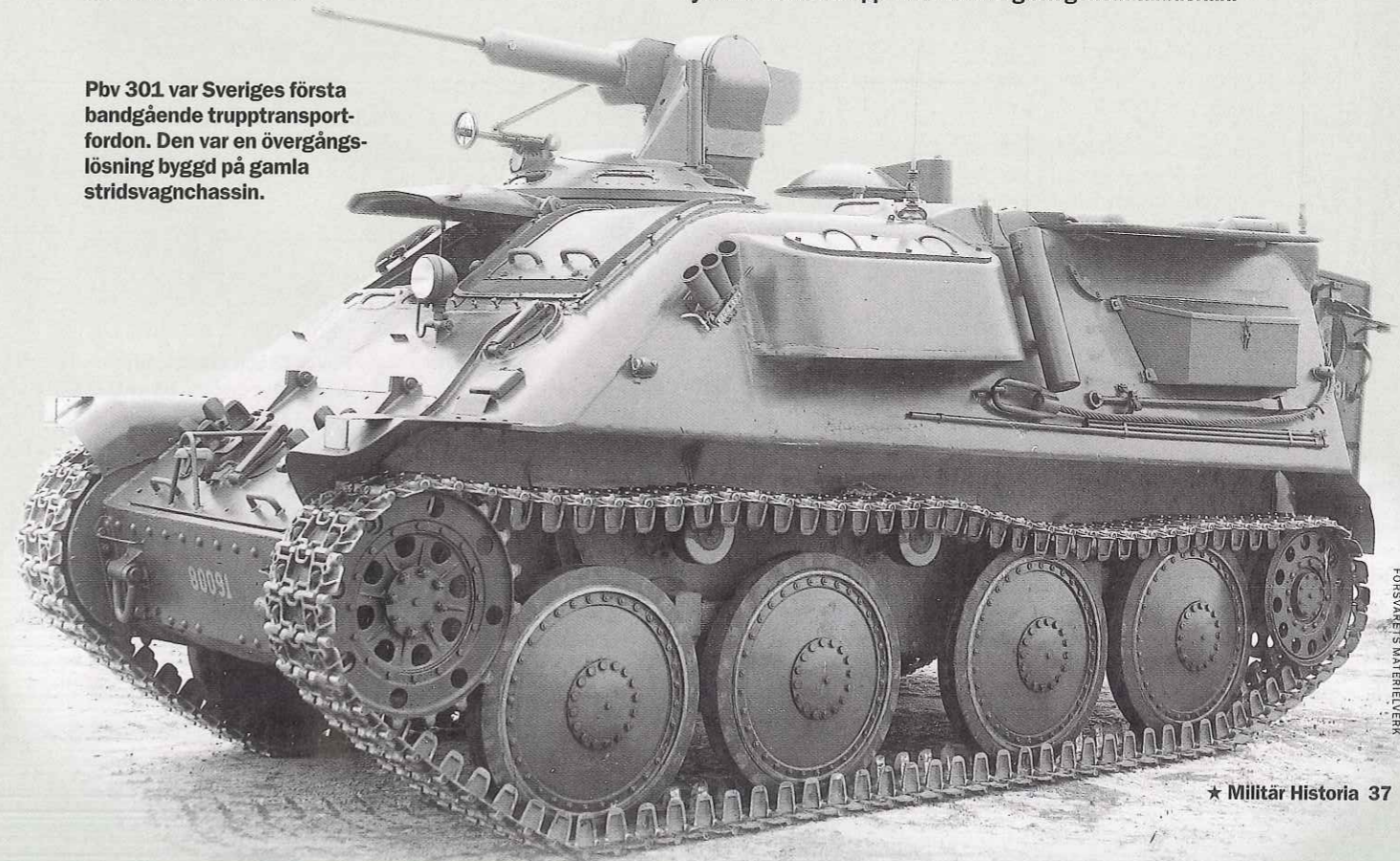
Trots trängsel kunde Pbv 301 transportera åtta soldater, av vilka fyra kunde strida uppsatt från vagnen genom takluckan.
