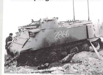
Pbv 302 efter ett verkansprov där en mina sprängts under larvbanden.
