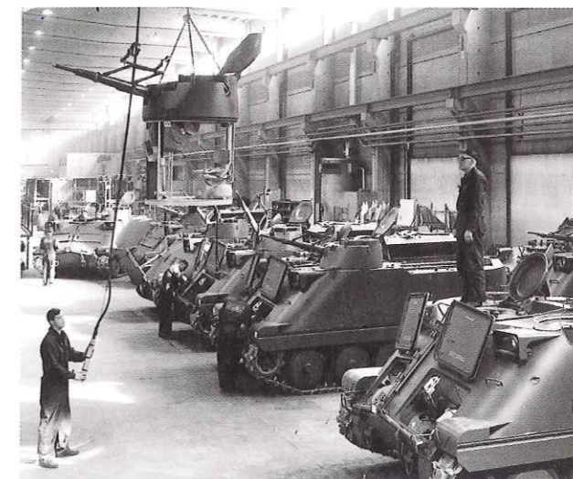
En vapenhuv till en Pbv 302 lyfts på plats för att monteras. Både Pbv 301 och 302 tillverkades av AB Hägglund & Söner.
