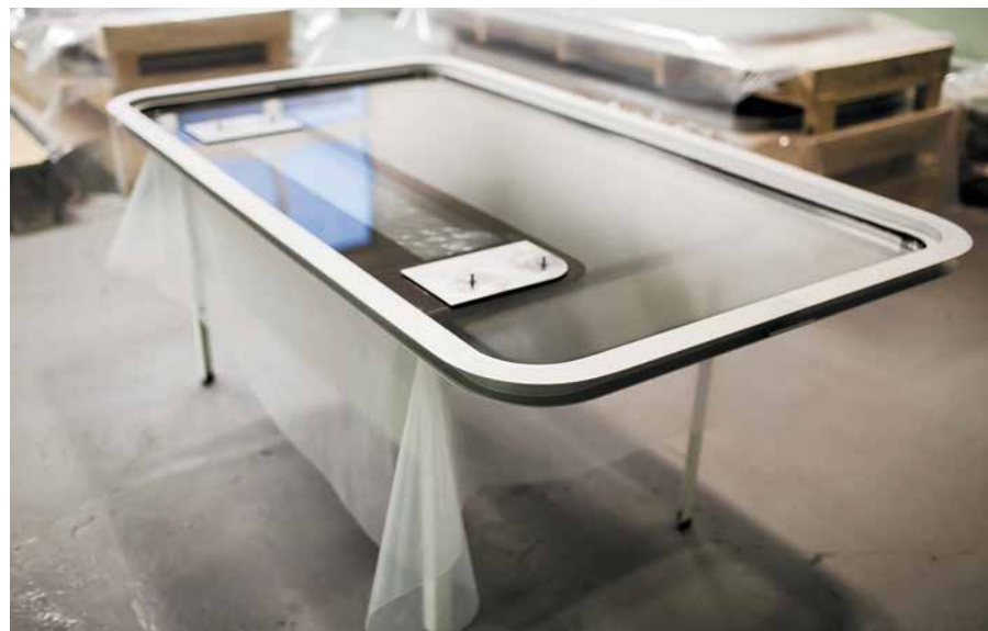
Глухое окно пассажирского вагона с вклеенным стеклопакетом
