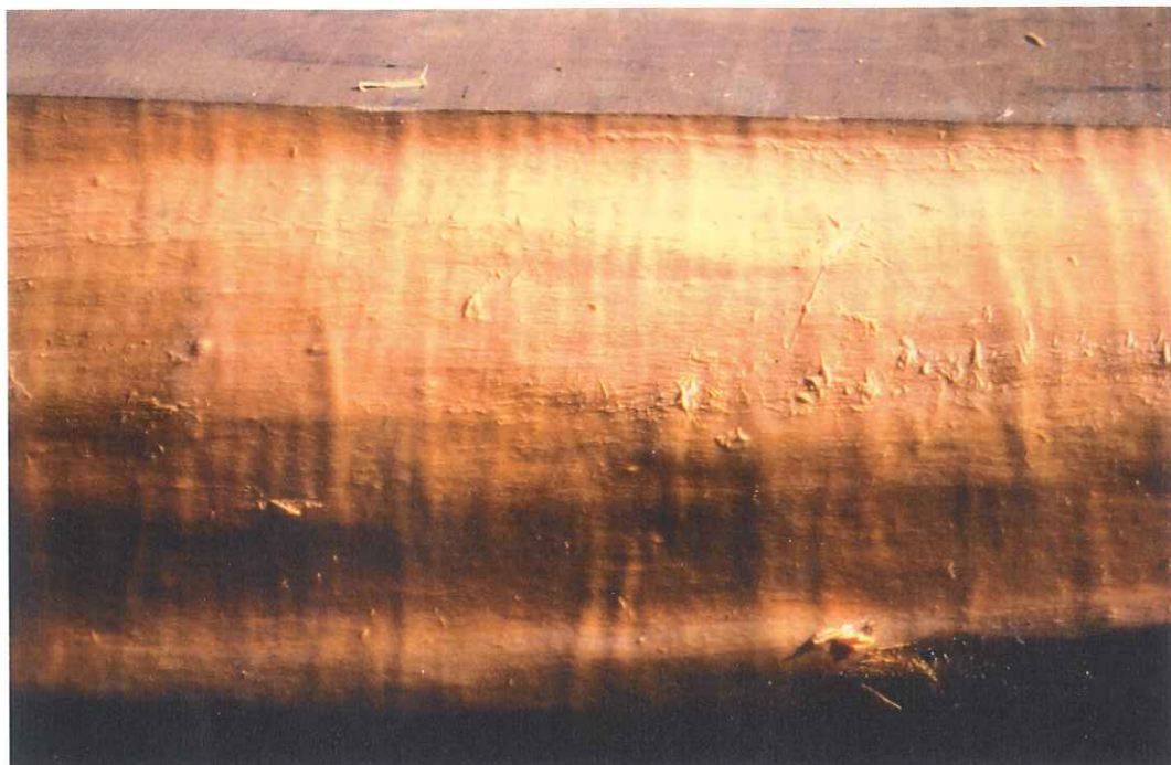
Abb. 7: Nach dem Trocknen zeigt das Elsbeerfurnier dieses Stammes die erwartete kräftige Riegelung
