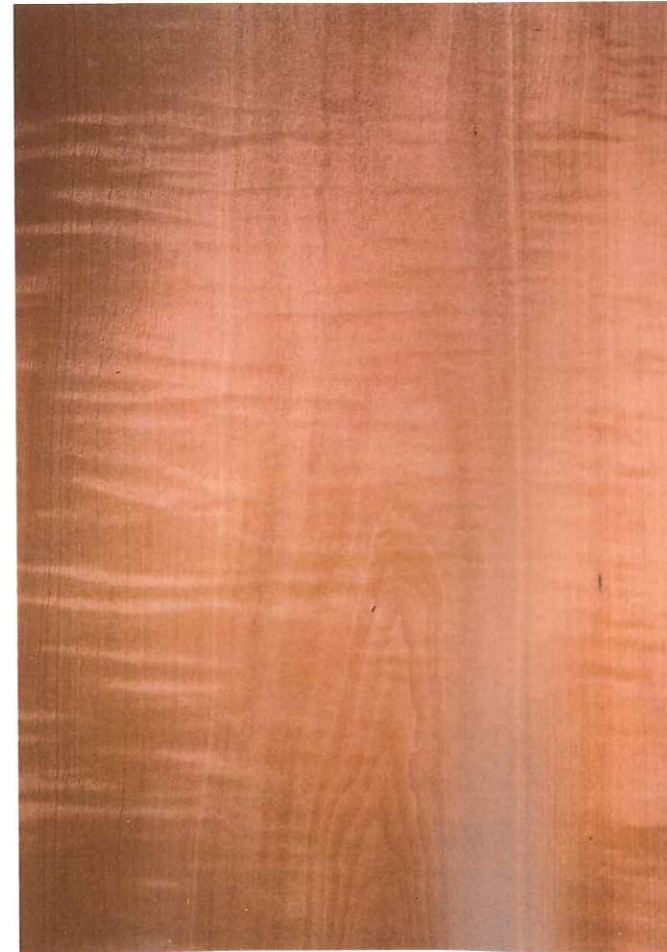
Abb. 12: Typische Ausprägung einer leichten Riegelung auf einem noch nicht verarbeiteten Elsbeerfurnier
