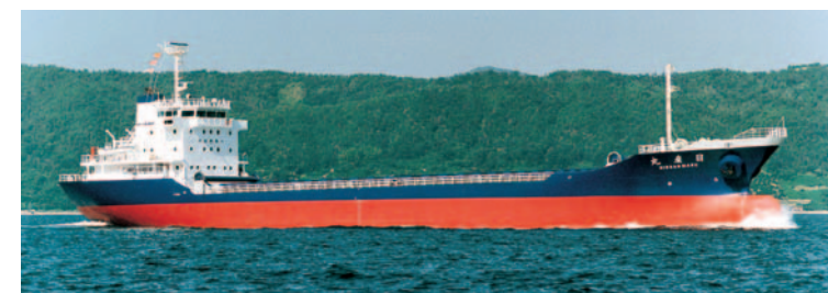
原料および一般貨物輸送 日産丸 5,954DWT 内航大型貨物船として石灰石・ニッケルスラグ・コークス・石炭など様々なバラ目の貨物を積載し、日本一円に航海しています。 Nissan Maru Multi-purpose ship for transport of limestone, coal, etc.
