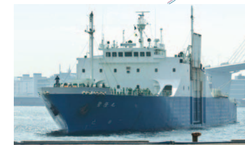
RORO船 碧隆丸 2,700DWT 国内初のコイル専用パレット輸送船 RORO ship: Hekiryu Maru A domestic dedicated steel coil carrier.
