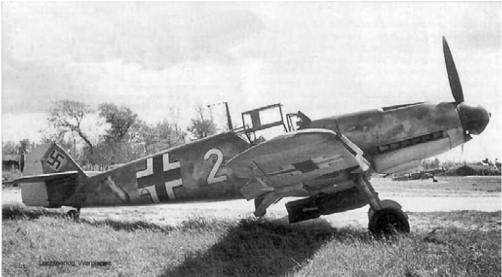
Bella immagine di un cacciabombardiere tedesco Bf 109 nella configurazione «Jabo». Notare la bomba da 250 kg sotto la carlinga.
