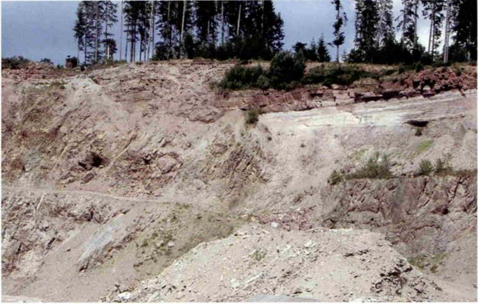
Abb. 2: Steinbruch im Gropptal, Zustand Juni 2003. Stark zerklüfteter Gneis, darüber Arkose-schichten des Rotliegenden (rechte Bildhälfte) und Buntsandstein. Eine in spitzem Winkel zur Bruchwand verlaufende Verwerfung hat Rotliegendes und Buntsandstein gegenüber dem davor liegenden, stark zerrütteten Gneis relativ abgesenkt. (Foto G. Reichelt)
