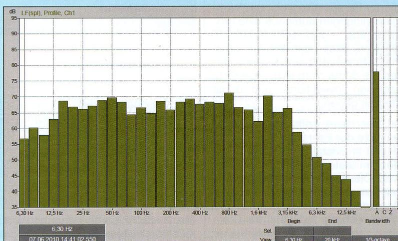
Abb.6: Spektrum der Vorbeifahrten nach Inbetriebnahme der Schienenschmieranlage (DB-Messung bei geschmierter Schiene).
