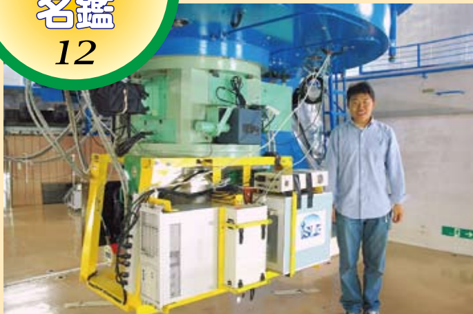
▲ 188cm 反射望遠鏡のカセグレン焦点に取り付けられた ISLE。光学系や検出器は真空容器の中に収められ、マイナス 200 度まで冷却される。エンジニアリングファーストライト時の写真なので、温度コントロールがガムテープで固定されているのはご愛敬。
