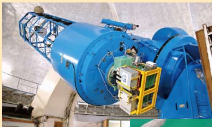
▲ 188cm 反射望遠鏡と ISLE の全体像。
