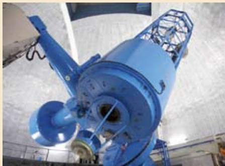
▲観測所のシンボル 188cm 反射望遠鏡。
