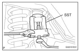
(d) Remove the bolt and bracket.
