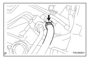
(d) Disengage the clip and disconnect the return hose.
