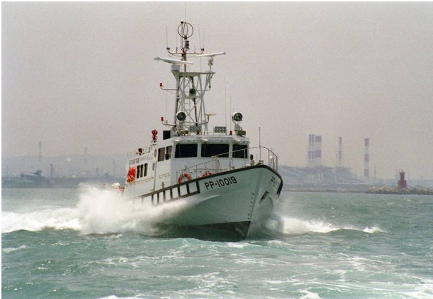
100噸級巡防艦 船長：約30米、船寬：約7米 材質：鋼質、最高航速：30節
