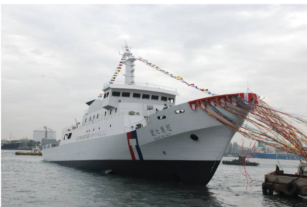
1,000噸級巡護艦(巡護七號) 船長：84.5米、船寬：12.5米 材質：鋼質船體、最高航速：21節
