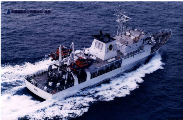
500噸級巡防艦(台北艦) 船長：61.41米、船寬：9.5米 材質：鋼質、最高航速：30節
