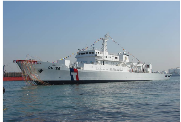
2,000噸級巡護艦(台南艦) 船長：98.5米、船寬：13.2米 材質：鋼質、最高航速：24節
