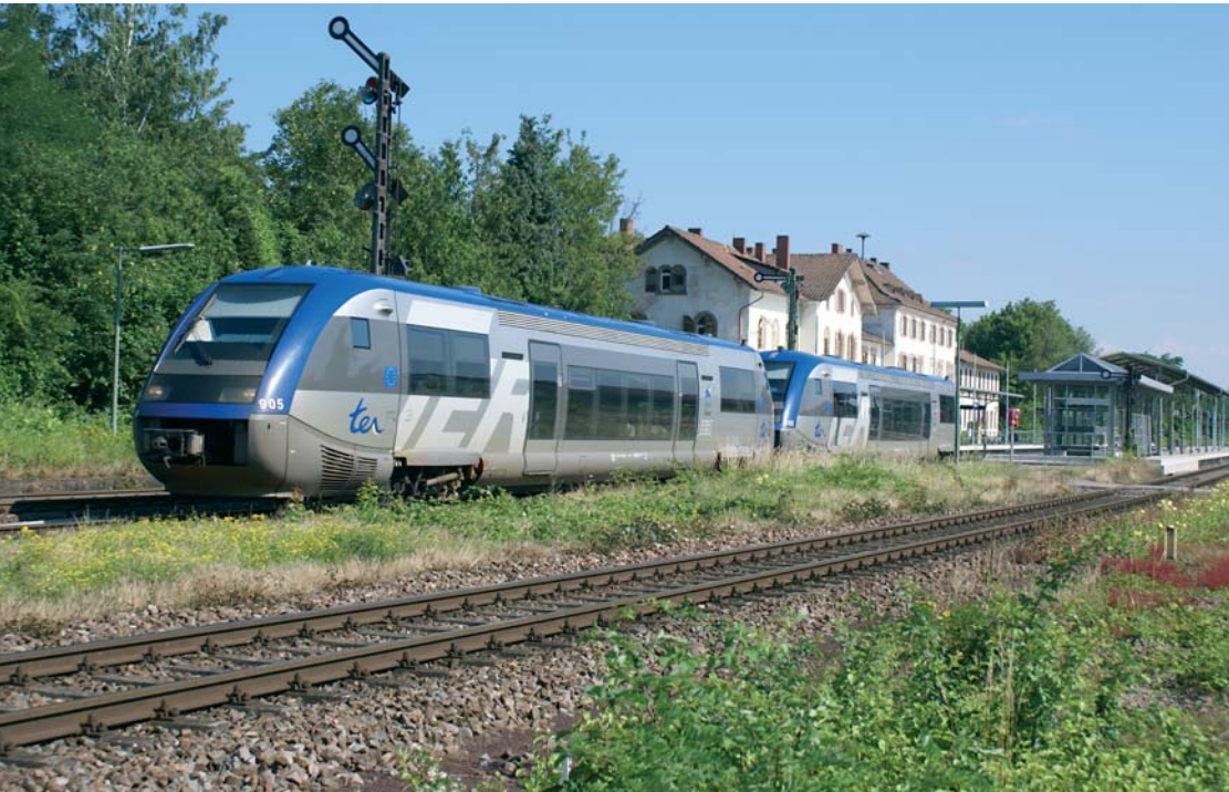
Derzeit können nur die französischen Baleine (Wal) vom Typ X 73900 sowohl auf französischen wie auf deutschen Strecken fahren. In Winden/Pfalz waren im Juli 2007 gleich zwei der schicken Triebwagen als Regionalexpress Neustadt/W – Strasbourg unterwegs.
