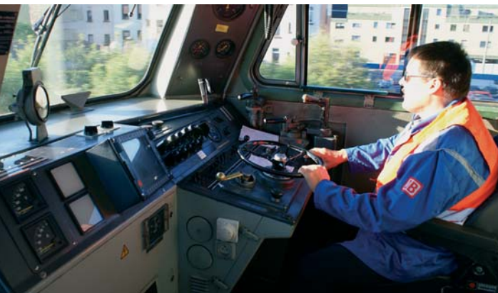
Der Führerstand der Diesellok 218 hat nur wenig gemeinsam mit dem „Cockpit“ eines ICE: Auffällig sind das große Handrad für die Geschwindigkeit und die drei Hebel für das Führerbremsventil sowie die Zusatz- und hydrodynamische Bremse.
