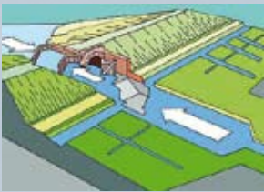
Schematische Darstellung einer Sielanlage
