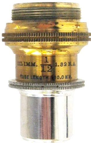
Bausch & Lomb Optical Co. Rochester, N. Y., Oil Imm. 1/12 1.32 N. A., Tube Length 160.0 MM. c1890. 41mm.
