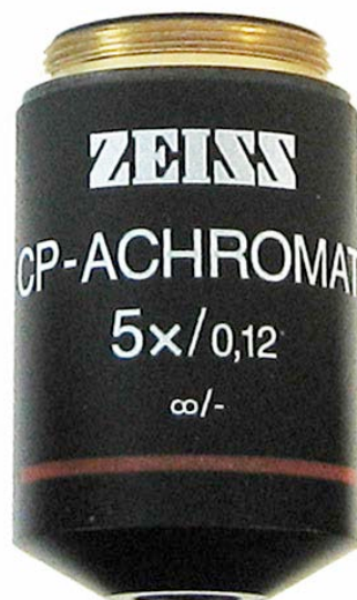
Zeiss, CP-Achromat, 5X/0,12, ∞/-, 440920. c2000. 38mm.
