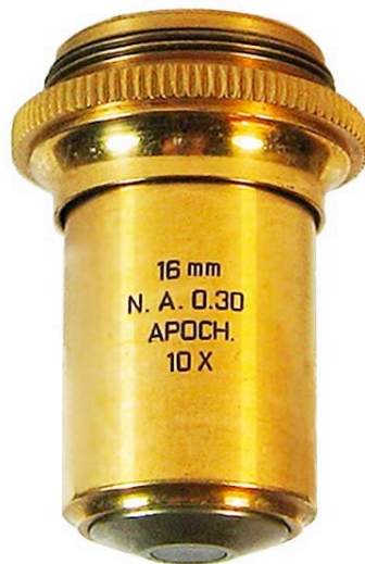
AO Spencer, 16 mm, N. A. 0.30, Apoch, 10 X, Made in U. S. A., A35998. c1940. 35mm.
